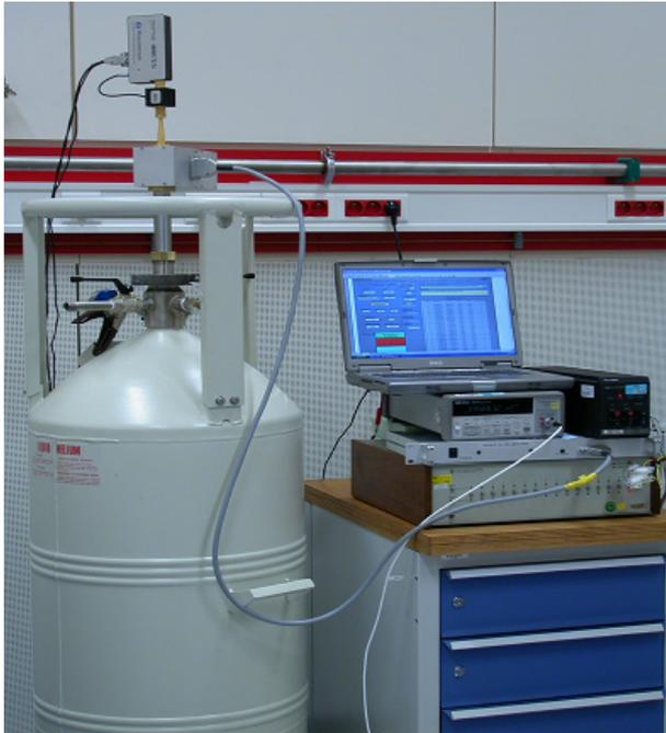
Fig. 7. – Banc d'étalonnage Josephson programmable ; à gauche, le synthétiseur HF, la canne cryogénique et le bidon d'hélium dans lequel est plongé le réseau de jonctions Josephson programmable ; à droite, le nanovoltmètre, la référence à diode Zener en étalonnage, la source de polarisation programmable, le commutateur programmable et l'ordinateur.
