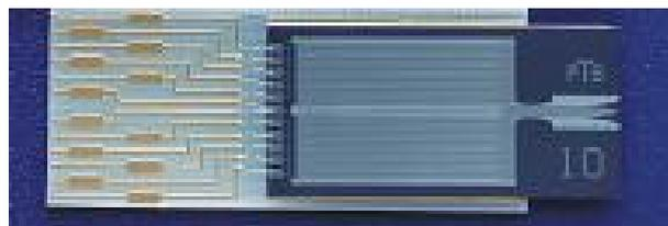
Fig. 5. – Réseau de jonctions Josephson programmable SINIS fabriqué par le PTB; le circuit hyperfréquence est formé de 64 branches contenant 128 jonctions Josephson; à droite, l'antenne hyperfréquence permettant de coupler le réseau au guide d'onde est visible.
