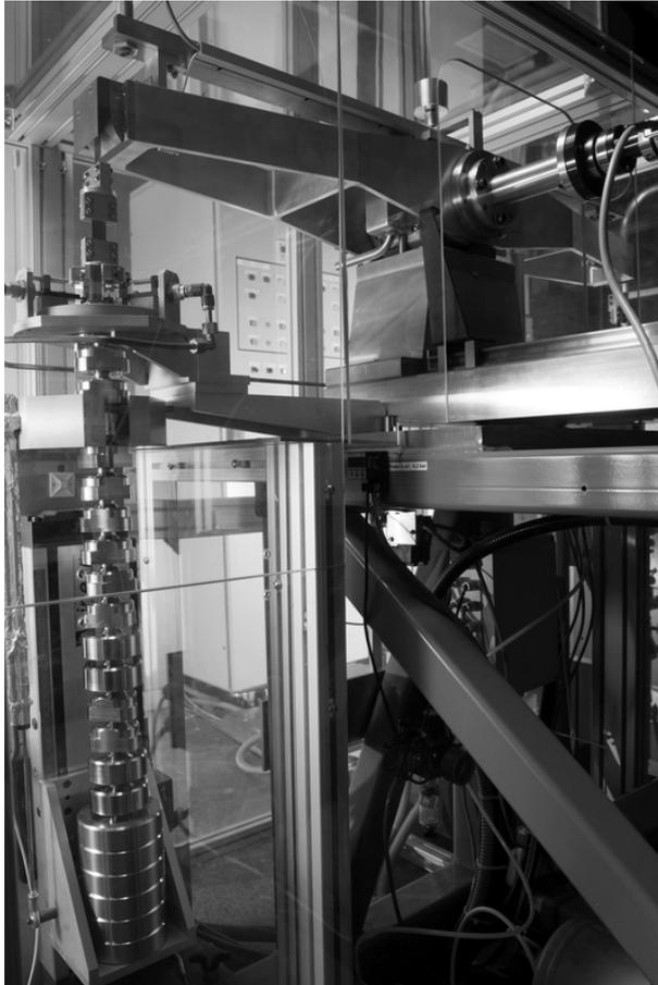
Fig. 2. – Photo du nouveau banc couple de 50 N·m du LNE.
