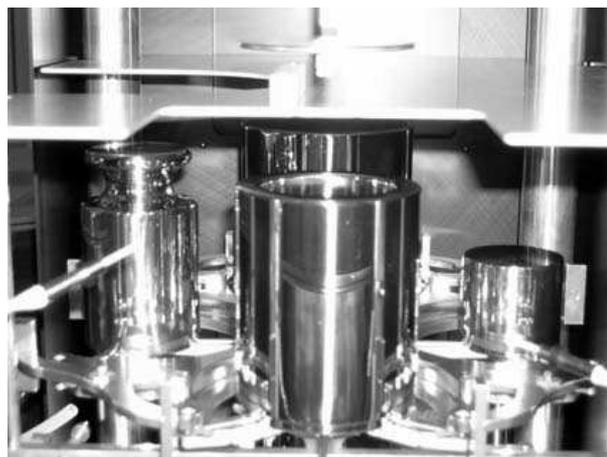
Fig. 3. – Étalonnage d'un étalon en acier inoxydable (à gauche) à partir d'un étalon en platine (à droite) en utilisant un couple d'artefact (avant : tube ; arrière : creux) sur le comparateur M-one.
