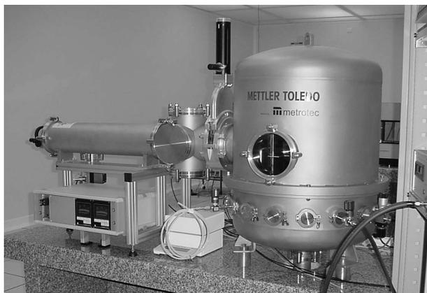
Fig. 2. – Comparateur M-one du LNE équipé de son sas d'introduction de masse sous vide.
