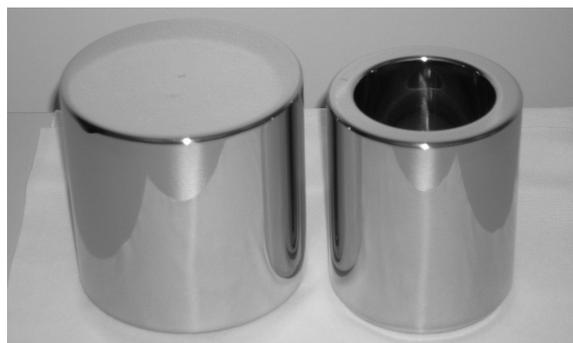
Fig. 1. – Artefacts pour la mesure de la masse volumique de l'air (à gauche : de type cylindre creux ; à droite : de type tube).
