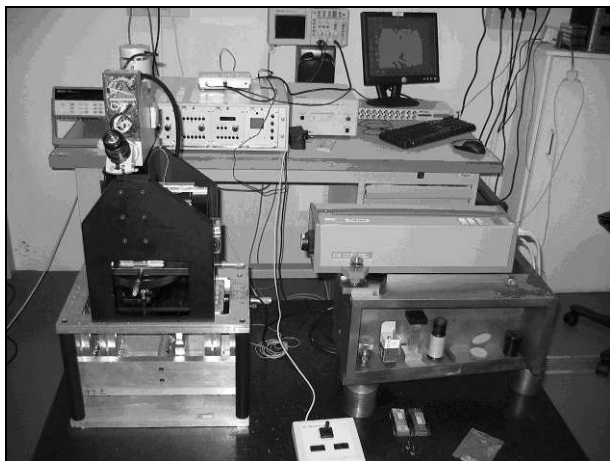
Fig. 3. – Vue d'ensemble du banc d'étalonnage des micromètres objets avec en premier plan à gauche la platine de translation à lames flexibles surmontée par un microscope photo-électrique.
