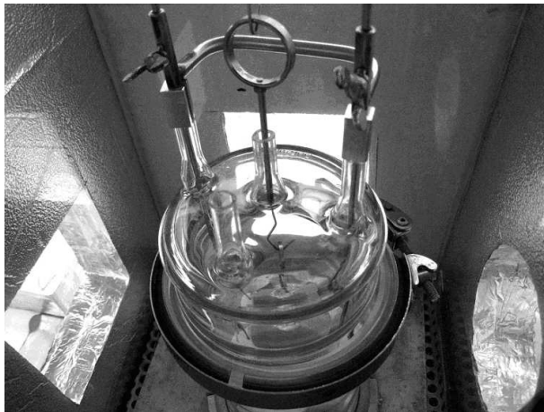
Fig. 2. – Vue du réacteur dans l'enceinte thermostatée : en premier plan apparaît le système d'accrochage du plongeur et de chargement-déchargement ; l'enceinte comporte quatre ouvertures latérales pour vérifier le centrage du plongeur.
