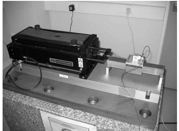
Fig. 3. – Exciteur basse fréquence sur son massif sismique.
