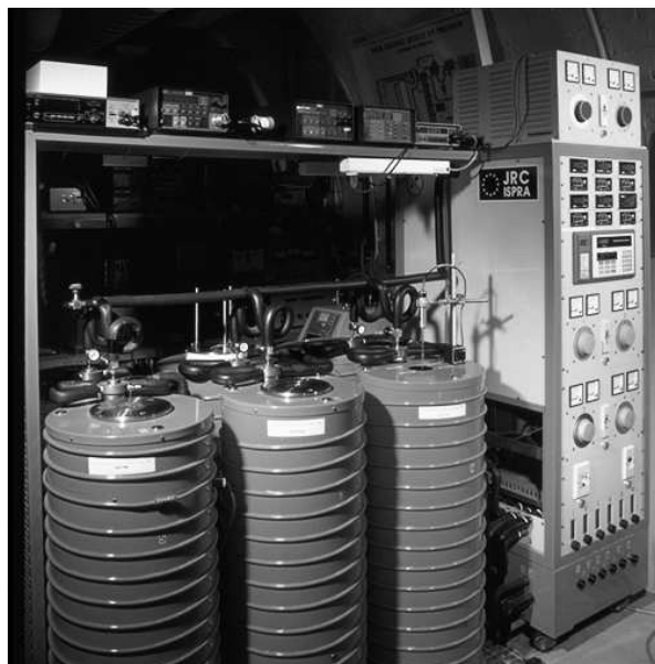
Fig. 5. – Vue d'ensemble du banc des caloducs incluant l'amplificateur de température.
