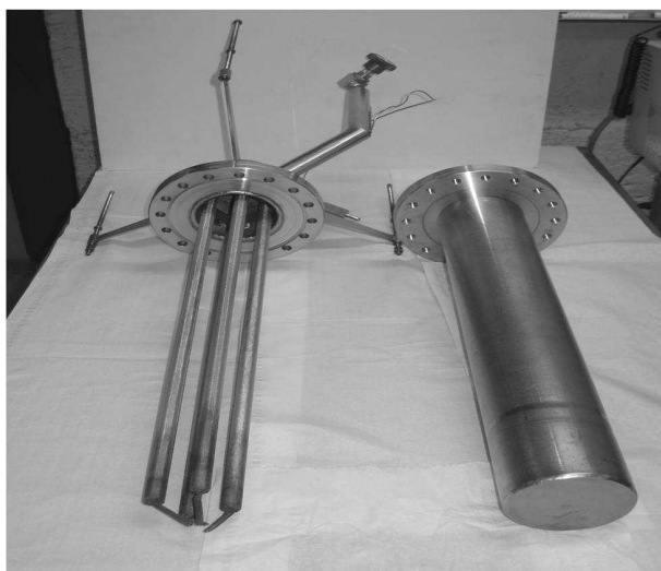
Fig. 7. – Intérieur du caloduc expérimental.
