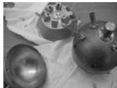
Fig. 2. – Sphère en cuivre pour les mesures de k .
