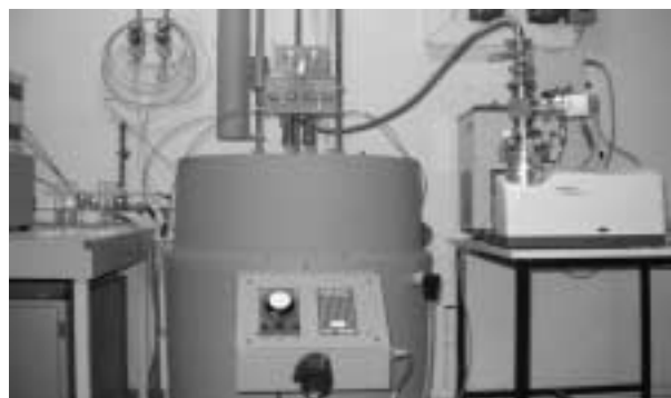
Fig. 7. – Calorimètre HT1000 avec introducteur d'échantillon thermostaté.
