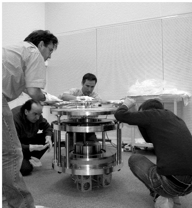
Fig. 3. – Montage du circuit magnétique.
