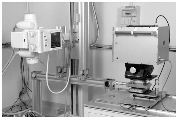
Fig. 2. – Installation du radiodiagnostic médical : tube à rayons X et chambre à parois d'air MD03 associée.
