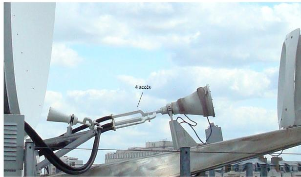
Fig. 13. – Vue rapprochée des deux cornets dont l’un est équipé d’un diplexeur à quatre accès.
