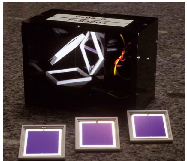
Fig. 2. – Intérieur d'un détecteur piège en réflexion construit avec des photodiodes de grande surface.
