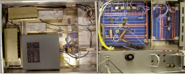
Fig. 10. – Source de courant du CCC du triangle métrologique, développée au LNE.
