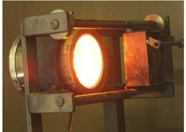
Fig. 1. – Échantillon en position d'essai face au four de la chambre à fumée.
