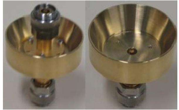
Fig. 5. – Cellules réalisées pour la mesure de liquides de DAS et liquides de référence.
