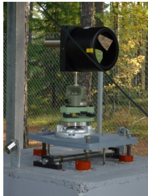
Fig. 12. – Support type et coin de cube pour les mesures de distance entre piliers.
