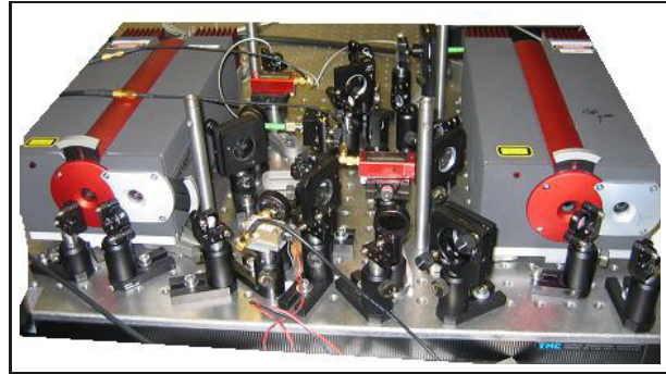
Fig. 2. – Système de génération de la longueur d'onde synthétique (breadboard 1 – dimensions : 0,45 m × 0,60 m).
