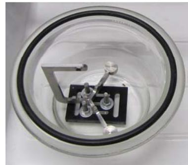
Fig. 4. – Bol du dessiccateur/saturateur avec le support à trois plots et la nacelle de pesée utilisée pour le protocole 1.
