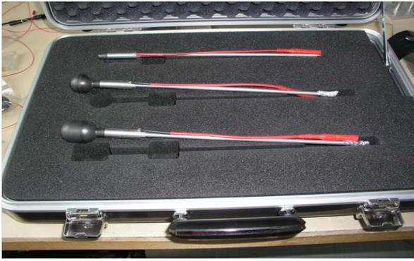
Fig. 1. – Photographie (du haut vers le bas) du manche factice, de la plus grosse chambre sphérique et de la plus grosse chambre cylindrique des nouvelles chambres d'ionisation du LNE-LNHB.
