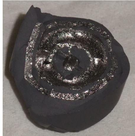
Fig. 8. – Échantillon de la cellule pyrométrique 6Cr2 cassée : la couronne métallique extérieure montre les feuilles C/C imprégnées par le métal.
