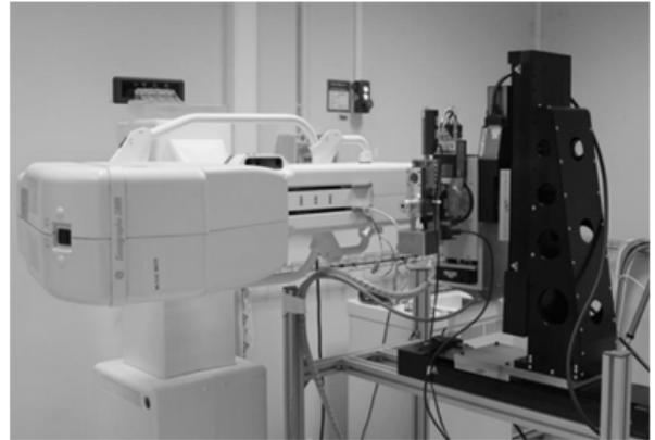
Fig. 5. – Banc avec un détecteur GeHP face au mammographe.
