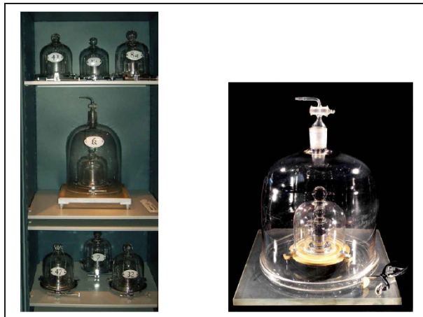
Fig. 1. – Figure de gauche (d’après Bordé [1]) : Coffre contenant le prototype international du kilogramme, conservé dans l’air au BIPM sous trois cloches de verre ainsi que ses six copies officielles ; figure de droite (d’après BIPM [2]) : Copie du prototype international du kilogramme ou IPK.
