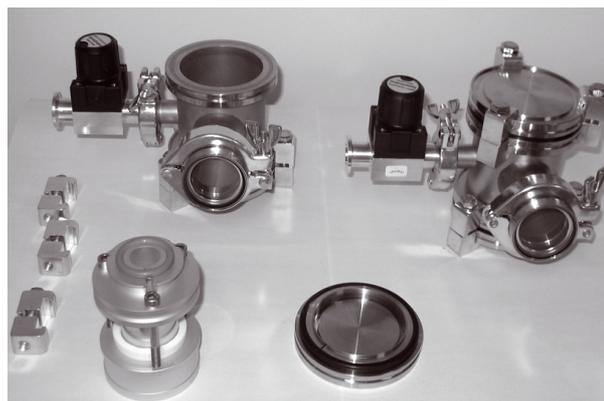
Fig. 12. – Boîtes de transfert à étalons de masse, l'une refermée (à droite), l'autre ouverte avec son support (à gauche).
